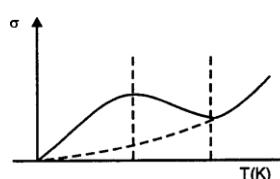
Specifična električna provodnost sa povećanjem temperature se uglavnom povećava (oblasti I i III) ali u jednom malom temperaturnom intervalu opada pa je temperaturni koeficijent otpornosti pozitivan (oblast II).
