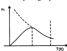
Pokretljivost nosilaca nanelektrisanja na apsolutnoj nuli je jednaka nuli. Sa povećanjem temperature se povećava i na određenoj temperaturi prolazi kroz maksimum i zatim se sa daljim povišenjem temperature smanjuje.
