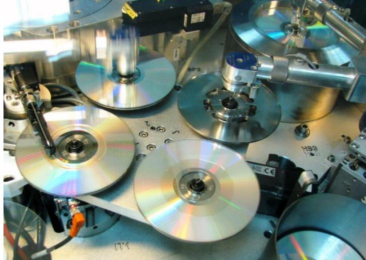
Sledi oblačenje posebnim slojem. Organski sloj koji se nanosi se kasnije služiti za čuvanje podataka. Proces se naziva spin coating: plastična podloga se vrti a sloj prska po površini sa spiralom.
