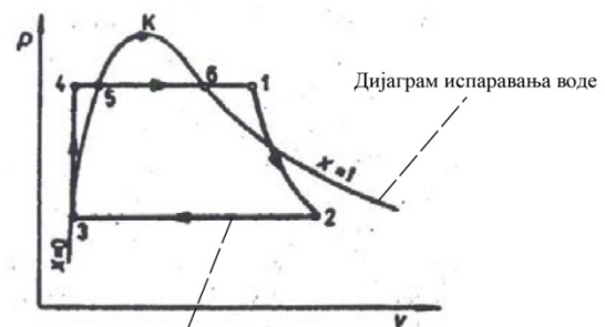
Основни теоријски циклус по којем раде парнотурбинска постројења (Ранкин-Клаузијусов циклус)
